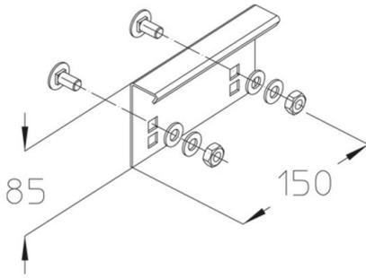
Elevación de tapas para el levantamiento de las tapas de bandejas autoportantes (grandes vanos) (6 WPD-A/3m). Las tapas deben fijarse con abrazaderas para tapa a una distancia de 100 mm de los extremos de la tapa y en el centro (6 WPDUK/3m). En las zonas expuestas al viento, el número de fijaciones debe aumentarse al menos a diez WPD-A y WPDUK por cada 3 m. En las zonas interiores, el uso de abrazaderas para la fijación de tapas es opcional. El volumen de llenado de la vía permanece sin cambios.
