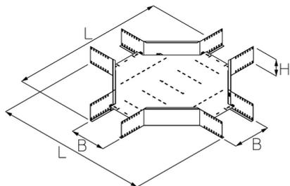
El cruce de bandejas portacables de luz ancha WLRK 200 con conectores integrados sirve como pieza moldeada para cruzar horizontalmente bandejas portacables de luz ancha. Es adecuado para las bandejas portacables de vano ancho WLR 200 y tiene anchuras de 200 a 600 mm. Las bandejas de conexión se pueden insertar con un conector de suelo VB. Diferentes materiales y superficies garantizan el cumplimiento de los requisitos de protección contra la corrosión de una amplia gama de aplicaciones.
