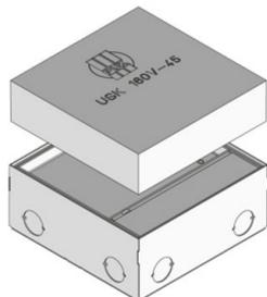
Conjunto de caja de empotrar, unidad portamecanismos cuadrada y cuerpo de encofrado, para montaje directo en forjado. Unidad portamecanismos de cajetín con salida de cables, junta de goma, palanca de apertura y cierre automático, para alojar máximo 2 mecanismos de 45x45mm. Con perforaciones en las paredes laterales para la entrada de tubo M25. Apta para pavimentos con limpieza en seco o húmedo. Diseñado para soportar las cargas habituales de tráfico en una oficina.
