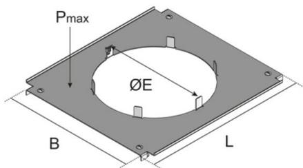
Tapa de montaje de chapa en acero galvanizada en caliente según método Sendzimir para colocar sobre perfil lateral de la parte inferior del canal para cables, incluido cierres. Utilizable como caja de registro y caja de mecanismos, con una apertura de montaje para la acogida de un tubo de encofrado que se sustituye en el montaje final por una unidad de montaje redonda.
