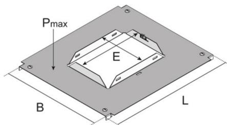
Tapa de montaje de acero galvanizado en caliente según método Sendzimir para colocar sobre perfil lateral de la parte inferior del canal para cables, incluido cierres. Utilizable como caja de registro y caja de mecanismos, con una apertura de montaje para la acogida de un cuerpo de encofrado que se sustituye en el montaje final por una unidad de montaje cuadrada.
