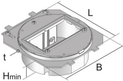
Cubeta de mecanismos redonda compuesta de una pletina UGET1-2 UG-R, una cubeta de mecanismos UG-R incluido descargas de tracción y una placa de recubrimiento UARM-4-1 118 para el montaje de hasta 2 mecanismos de 45x45 mm. Para el enganchado independiente en la altura en salidas individuales destinadas al montaje en falsos suelos.
