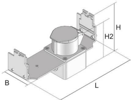
Portamecanismo de acero galvanizada con enchufe CEE y bornes de fijación para colocar en una unidad de montaje. El montaje tiene lugar centrado en el lugar de una cubeta portamecanismos. Se recomienda utilizar una clavija angular. Alargo de encaje opcional. Se debe tener en cuenta la altura de montaje necesaria en el solado Hmin.
