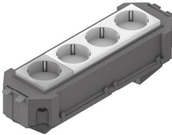
Cubetas de mecanismos preconfeccionadas, completas, con conectores snap-in Wieland de 3 polos y una toma de enchufe triple así como una toma de enchufe simple precableadas. Apropriadas para líneas de conexión clavija-toma. Incluyendo todas las coberturas y materiales de montaje. Con posibilidades de montaje en el área del suelo de la cubeta de mecanismo.
