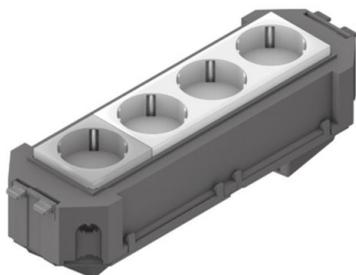
Cubetas de mecanismos preconfeccionadas, completas, con conectores snap-in Wago de 3 polos y una toma de enchufe triple así como una toma de enchufe simple precableadas. Apropriadas para líneas de conexión clavija-toma. Incluyendo todas las coberturas y materiales de montaje. Con posibilidades de montaje en el área del suelo de la cubeta de mecanismo.
