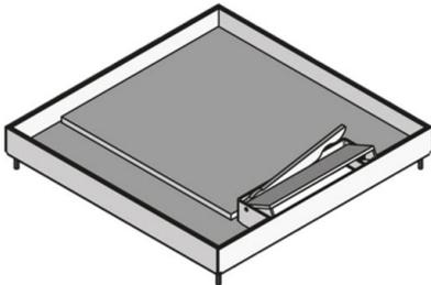
Unidad portamecanismos cuadrada fabricada en acero inoxidable con reborde. Marco de montaje para cargas pesadas, tapa abatible con cierre automático, salida de cables a ras de suelo y palanca con mecanismo de cierre automático y junta de goma. Para montar en cajas de suelo, tapas de montaje y suelos técnicos. Admite 3 cubetas para máximo 12 mecanismos de 45x45 mm. Apta para pavimentos con limpieza en seco o húmedo. Diseñado para soportar cargas de tráfico pesadas.
