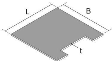
Inserto de tapa de espuma rígida de PVC como llenado para la reducción de la profundidad de inserción del revestimiento del suelo del cajetín en acero inoxidable
