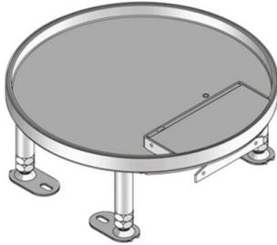
Unidad portamecanismos redonda fabricada en acero inoxidable. Incluye marco de montaje nivelable con salida de cables, palanca de apertura con cierre automático y junta de goma. Admite máximo 2 cubetas portamecanismos y 6 mecanismos de fijación mediante tornillo, o bien, 8 mecanismos de 45x45mm. Apta para pavimentos con limpieza en seco o húmedo. Diseñado para soportar las cargas habituales de tráfico en una oficina.
