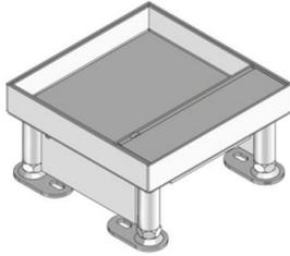
Unidad portamecanismos cuadrada con junta de goma para alojar máximo 2 mecanismos de 45x45mm. Unidad portamecanismos de cajetín nivelable con salida de cables, palanca de apertura con cierre automático y junta de goma. Apto para pavimentos que necesiten limpieza en seco. Diseñado para soportar las cargas habituales de tráfico en una oficina.
