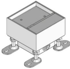
Unidad portamecanismos cuadrada fabricada en acero inoxidable con reborde para la instalación de un mecanismo de 45x45 mm. Incluye marco de montaje nivelable, tapa con salida de cables a ras de pavimento, palanca de apertura con cierre automático y junta de goma. Apta para instalar en cajas de suelo y suelo técnico. Apropiaada para estancias con revestimientos de pavimento con limpieza en seco y mojado. Admite todas las cargas dinámicas propias de una oficina.
