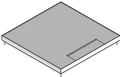
Marco y tapa fabricada en acero inoxidable, superficie pulida. Incluye marco de montaje con salida de cable a ras de pavimento, palanca de apertura con cierre automático y junta de goma. Para colocar sobre marcos de nivelación. Admite 3 cubetas para máximo 12 mecanismos de 45x45 mm. Apta para pavimentos con limpieza en seco o húmedo. Diseñado para soportar las cargas habituales de tráfico en una oficina.
