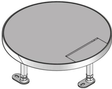
Unidad portamecanismos redonda fabricada en acero inoxidable, superficie pulida con reborde. Incluye marco de montaje nivelable con salida de cables, palanca de apertura con cierre automático y junta de goma. Admite 3 cubetas para máximo 12 mecanismos de 45x45 mm. Apta para pavimentos con limpieza en seco o húmedo. Diseñado para soportar las cargas habituales de tráfico en una oficina.
