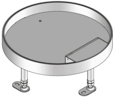
Unidad portamecanismos redonda fabricada en acero inoxidable. Incluye marco de montaje nivelable con salida de cables, palanca de apertura con cierre automático y junta de goma. Admite 3 cubetas para máximo 12 mecanismos de 45x45 mm. Apta para pavimentos con limpieza en seco o húmedo. Diseñado para soportar las cargas habituales de tráfico en una oficina.
