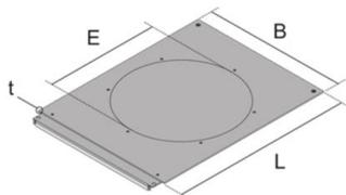
Galvanizado en caliente según método Sendzimir, según DIN EN 10346
