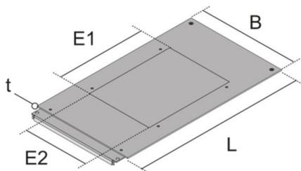
Tapa de montaje fabricada en acero galvanizado en caliente-senzimir, pretroquelada para unidad portamecanismos rectangular. Para ser utilizado en sustitución de una tapa ciega doble en una unidad portamecanismos. Diseñado para soportar las cargas habituales de tráfico en una oficina.
