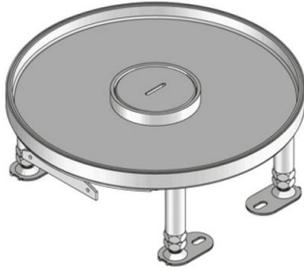
Unidad portamecanismos redonda fabricada en acero inoxidable. Incluye marco nivelable, tapa con salida de tubo, juego de montaje para tubo de aluminio roscado y junta de goma, para instalar en cajas de empotrar, tapas de montaje y suelo técnico. Admite máximo 2 cubetas portamecanismos y 6 mecanismos de fijación mediante tornillo, o bien, 8 mecanismos de 45x45mm. Apto para suelos que necesiten limpieza con agua. Diseñado para soportar las cargas habituales de tráfico en una oficina.
