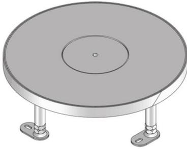
Unidad portamecanismos redonda fabricada en acero inoxidable, superficie pulida con reborde. Incluye marco nivelable con salida de tubo, juego de montaje para tubo y junta de goma. Para colocar en cajas de empotrar y en suelos técnicos. Admite 3 cubetas para máximo 12 mecanismos de 45x45 mm. Apto para suelos que necesiten limpieza con agua. Diseñado para soportar las cargas habituales de tráfico en una oficina.
