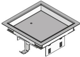
Unidad portamecanismos cuadrada fabricada en acero inoxidable para utilizar como tapa de registro. Incluye marco de montaje con tapa ciega y junta de goma. Apropiado para montar sobre cajas de empotrar o en suelo técnico. Apto para pavimentos que necesiten limpieza en seco o mojado. Preparado para el tráfico habitual de una oficina.
