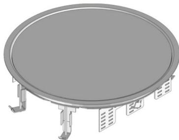
Unidad portamecanismos redonda con marco de protección , fabricada en acero inoxidable Superficie plana granallada. Incluye marco de montaje, tapa ciega, junta de goma y juego de garras universal. Apropiado para montar en cajas de suelo, tapas de montaje y suelos técnicos. Apta para pavimentos con limpieza en seco o húmedo. Diseñado para soportar las cargas habituales de tráfico en una oficina.
