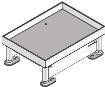
Unidad portamecanismos rectangular en acero inoxidable con marco protector. Incluye marco nivelable, tapa ciega y junta de goma. Para instalar en cajas de empotrar, tapas de montaje y suelo técnico. Apta para pavimentos con limpieza en seco o húmedo. Diseñado para soportar las cargas habituales de tráfico en una oficina.
