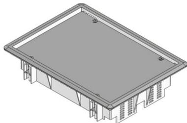
Unidad portamecanismos ciega cuadrada de poliamida con marco de protección de moqueta. Como marco de montaje con inserto de acero, incluido juego de garras de fijación universal. Apta para montar en cajas de suelo, tapas de montaje y suelo técnico. Apropiaada para estancias con revestimiento de pavimento de hasta 8 mm con limpieza en seco. Diseñado para soportar las cargas habituales de tráfico en una oficina.
