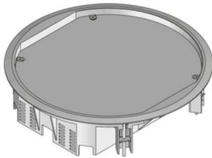
Unidad portamecanismos ciega redonda de poliamida con marco de protección de moqueta. Como marco de montaje con inserto de acero, incluido juego de garras de fijación universal. Apta para montar en cajas de suelo, tapas de montaje y suelo técnico. Apropiaada para estancias con revestimiento de pavimento de hasta 8 mm con limpieza en seco. Diseñado para soportar las cargas habituales de tráfico en una oficina.
