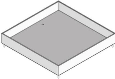
Cajetín cuadrado de chapa en acero inoxidable con reborde. Como marco de montaje con cajetín de inserto ciego, junta de goma y tornillos de fijación para montar sobre unidades de nivelado, en cajas de suelo, tapas de montaje, aperturas de doble suelo o falso suelo. Apropiado para estancias con revestimientos del suelo cuidados en seco y en mojado. Concebido para las cargas dinámicas de una oficina.
