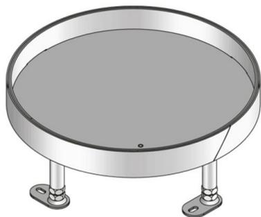
Cajetín redondo de chapa de acero inoxidable con borde de unión. Incluye marco de montaje ciego y junta de goma para colocar en cajas de empotrar y suelos técnicos. Apto para suelos que necesiten limpieza con agua. Diseñado para soportar las cargas habituales de tráfico en una oficina.
