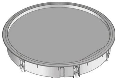
Unidad portamecanismos redonda, con marco de protección para moqueta. Como marco de montaje con inserto de acero, incluido juego de garras de fijación universal. Apta para montar en cajas de suelo, tapas de montaje y suelo técnico. Apta para pavimentos con limpieza en seco y espesor máximo de 10 mm. Diseñado para soportar las cargas habituales de tráfico en una oficina.
