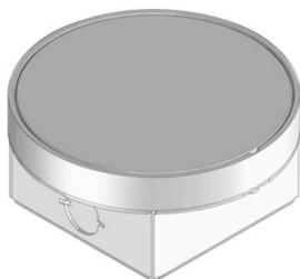
Toma de limpieza redonda fabricada en aluminio con borde. Incl. un adaptador blanco aislado de tierra. Como unidad nivelable con tapa de tubo, carcasa de chapa de acero. Para instalación directa en suelos de solera. Adecuado para habitaciones con poca estructura de suelo y revestimientos de suelo limpios en húmedo. Diseñado para soportar las cargas habituales de tráfico en una oficina.
