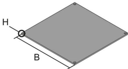
Chapa de acero cuadrada galvanizada en caliente según método Sendzimir para la tapa ciega y sin marco de una unidad de nivelado. Apropiaada para estancias con revestimientos del suelo cuidados en seco o en húmedo. Concebido para las cargas dinámicas de una oficina.
