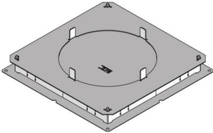
Caja para suelo compuesta de un cajón de acero galvanizado en caliente según método Sendzimir, con paredes laterales doblables hacia arriba por todos los lados, incluido borne de puesta a tierra para un montaje sin ruido de pasos y sin necesidad de nivelación. Utilizable como caja de registro y caja de mecanismos, con una apertura de montaje para la acogida de una unidad de encofrado que se sustituye en el montaje final por una unidad de montaje de poliamida redonda.
