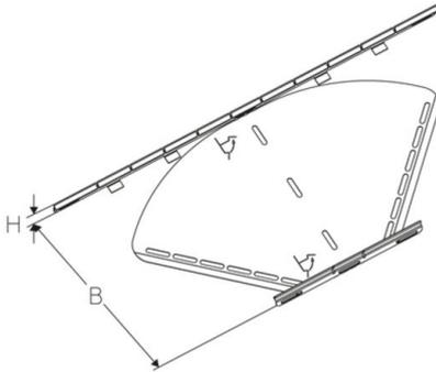
Curva de bandeja variable de 0-90 grados para el cambio de dirección horizontal con uniones integrados. Con orificios alargados para la fijación de separadores o soportes. Para obtener una mayor rigidez en ángulos mayores, el lado exterior puede conectarse a la base a partir de una anchura de 200 mm. Para proteger los cables, los bordes de la parte superior de la curva de bandeja variable están doblados.
