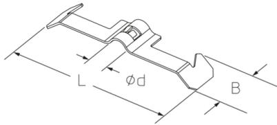
Die GK-A Gitterbahnklemme ist einfach zu installieren, an z.B. KHA-Profilen bzw. Strutmontageschienen. Es spart somit Zeit bei der Befestigung einer Gitterbahn. GK-A an der gewünschten Stelle über der Gitterbahn platzieren, Klemme zusammendrücken und an den gewünschten Platz schieben. Die Installation erfolgt ohne Hilfsmittel oder zusätzliches Befestigungsmaterial.
