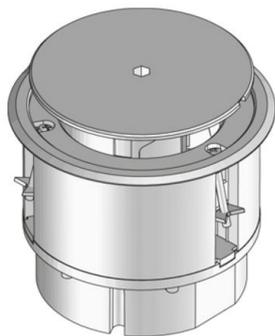
Salida de cables redonda de plástico formada con marco de protección de pavimento, tapa giratoria con salida de cables y juego de garras para su fijación. Apropriada para instalar en suelos empotrados y suelos técnicos. Apta para estancias con revestimientos de suelo con limpieza en seco. Admite todas las cargas dinámicas propias de una oficina.
