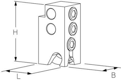
La regleta de bornes de conexión equipotencial para canal de suelo BKPA de latón puede fijarse en los orificios previamente eliminados de las paredes laterales del canal de suelo. De este modo, todo el sistema de canalización de suelo puede incluirse en la conexión equipotencial de toda la instalación, para proteger los equipos eléctricos y evitar descargas eléctricas.
