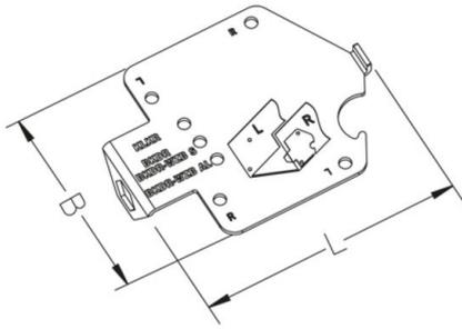
La multiherramienta del canal del suelo se utiliza principalmente como plantilla. Puede utilizarse para marcar las posiciones de los conectores y los tensores. La herramienta también es adecuada para eliminar los tacos y apretar los tensores.
