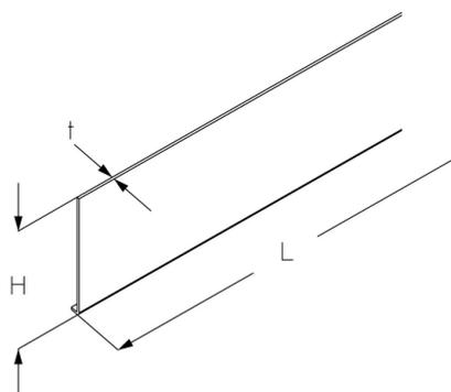
El revestimiento lateral para conductos de suelo BKHR SV S se utiliza cuando el conducto de suelo está elevado mediante soportes para conductos de suelo BKHR. Los revestimientos laterales se utilizan para conductos de suelo elevados para proporcionar resistencia al deslizamiento y evitar depósitos debajo de los conductos de suelo. Tienen una altura de 108 mm, una longitud de 1000, 1500 o 3000 mm y están fabricados en acero galvanizado en caliente sendzimir.
