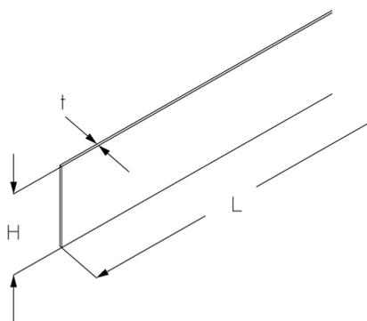
El embellecedor lateral para canal de suelo BKHCSV S se utiliza cuando el canal de suelo está elevado mediante soportes para canal de suelo BKHC. Los embellecedores laterales protegen contra pisadas y suciedad en canales de suelo elevados y cierran el sistema de canales de suelo por debajo. Tienen una altura de 90 mm, una longitud de 1000, 1500 o 3000 mm y están fabricados en acero galvanizado en caliente sendzimir.
